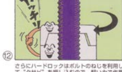
⑫ さらにハードロックはボルトのねじを利用して「クサビ」を押し込むので、軽い力で作業でき、当然取りはずしも簡単です。
