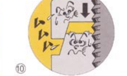
⑩ 断面図をこらんで下さい。下ナットのAが「クサビ」の役目を果たし、上ナットの空目Bに押し込めば、「クサビ効果」が発揮され、強力なロック状態になります。
